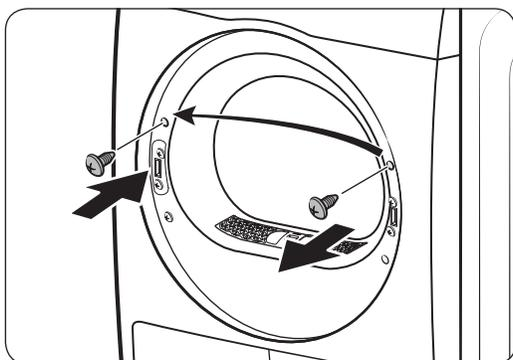
5. Rimuovere la vite superiore della cornice dello sportello sulla sinistra della cornice stessa, quindi inserirla nel foro destro della cornice dello sportello. Non rimuovere le viti della staffa inferiore.
