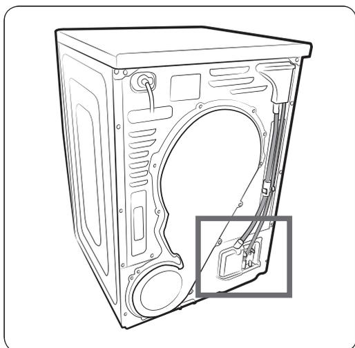
L'asciugatrice viene fornita in dotazione con un serbatoio incorporato. Tuttavia, qualora non si desidera utilizzarlo, è possibile installare il tubo di scarico. Il tubo di scarico, accessorio in dotazione (tubo di scarico lungo), può essere utilizzato come una prolunga del tubo di scarico.
