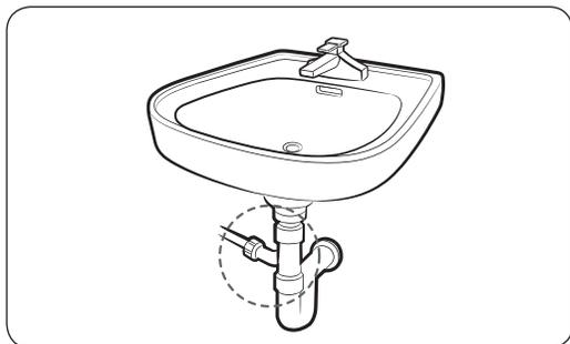
2. Collegare l'adattatore del tubo direttamente al tubo di scarico del lavandino.
