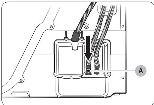
2. Inserire una estremità del tubo accessorio (tubo di scarico lungo) nel **foro (A)**.
