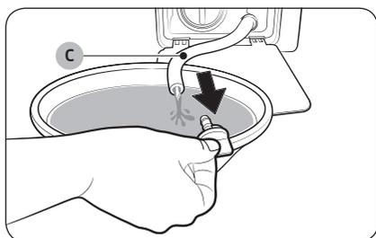
4. Aprire il tappo del tubo e lasciare defluire l'acqua attraverso il **tubo di scarico di emergenza (C)** nel contenitore.
