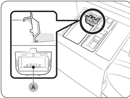
Inserire per primo il contenitore per liquidi in dotazione nel **II** **comparto lavaggio principale**. Quindi, versare il detersivo liquido nel contenitore sotto la **linea max (A)**.
