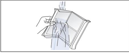
7. Asciugare i filtri per lanugine, chiuderlo e reinserire il filtro per lanugine a due componenti.
